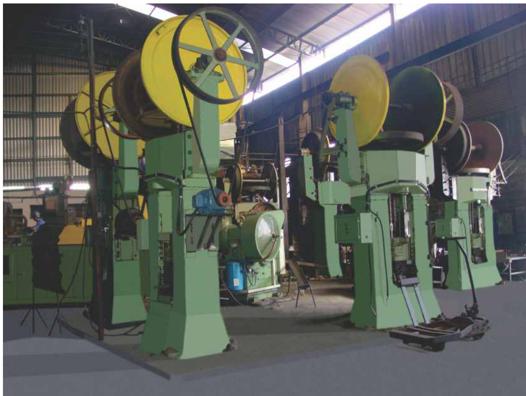
A Lontra tem prensas de 200 ton a 800 ton para forjamento de peças de 0,5 kg a 15kg.
